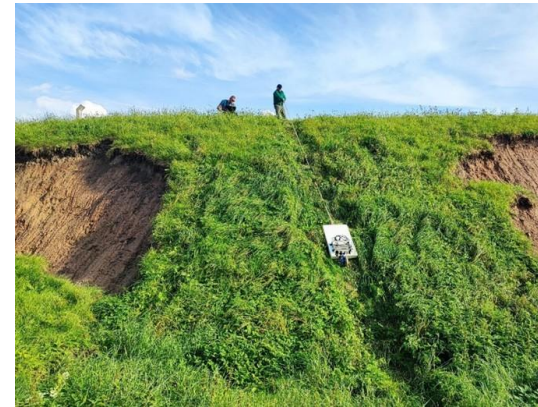
6 pav. Papilės II piliakalnio pietvakarinis šlaite tarp nuošliaužų atliekamas georadaro profilis
