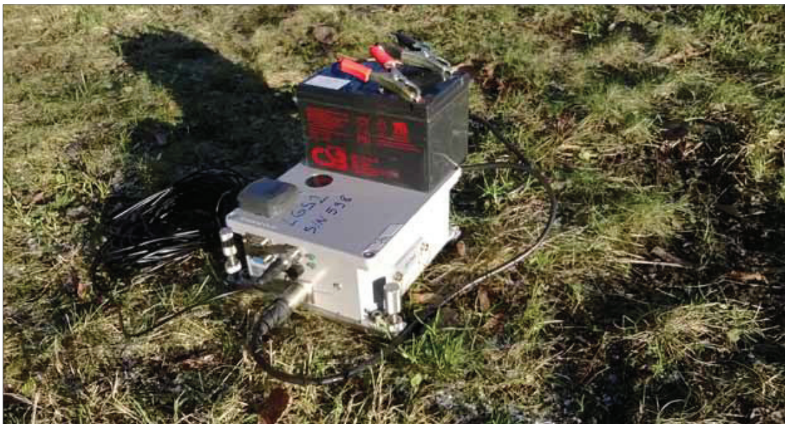
2 pav. Portatyvinė seisminė stotis (LGS2). Akumuliatorius kaip maitinimo šaltinis ir GPS antena uždėti ant duomenų registracijos modulio SARA SL07
