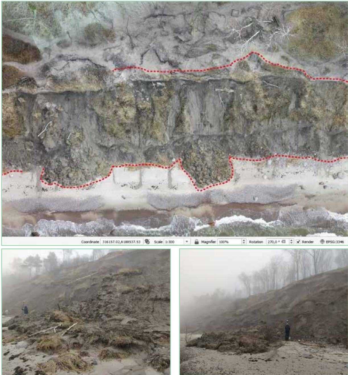
2 pav. Girulių ir Karklės ruožo ortofotografiname žemėlapyje (2021-04-02 skridimas) matyti didžiausios ir naujausios grunto slinkties, geodeziškai apkontūrintos skardžio papėdėje prieš keletą dienų. Lineamentus galima dar patikslinti pagal šį ortofotožemėlapij arba sukurti kitus reikalingus žemėlapius. Šio tyrimų komplekso duomenų pakanka nuslinkusio grunto tūriui apskaičiuoti bei įvertinti kitus krantų pokyčius.
