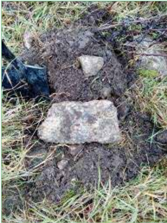
5 pav. Išilgai profilio (4 pav.) iškasti šurfai su aptiktomis atliekomis.
