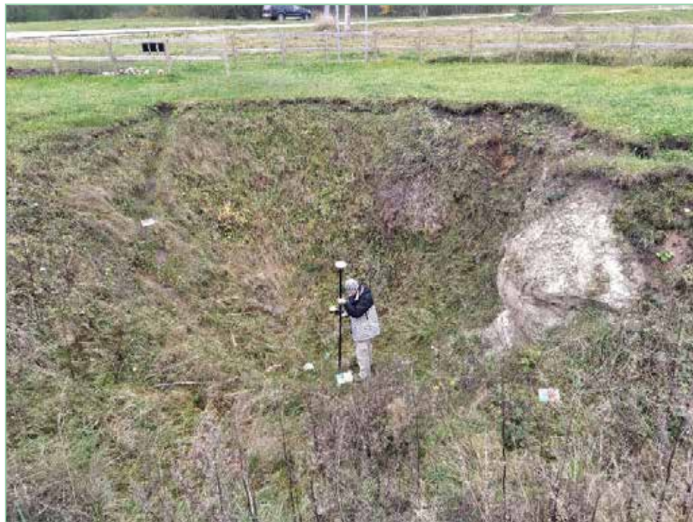
5 pav. Detalūs papildomi darbai Mantagailiščio ir Karajimiškio kaimuose įrengiant GCP taškus aeronuotraukų tikslesniam pririšimui
